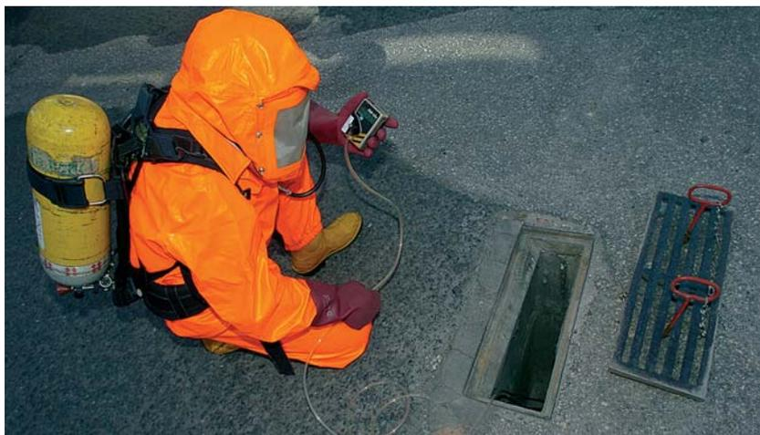
Fig. 2 Medição com explosímetro.
