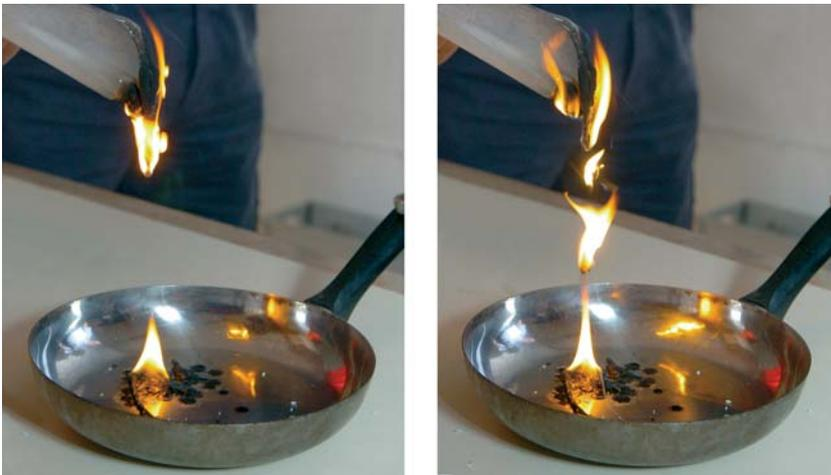
Fig. 21 Fusão de termoplásticos.
