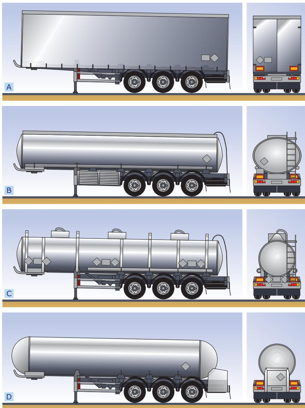
Fig. 28 Alguns tipos de contentores/cisternas utilizados no transporte de matérias perigosas. A – Carga geral; B – Líquidos; C – Corrosivos; D – Gases.
